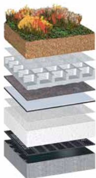
Warstwy dachu zielonego Warstwa ochronna FSM 600 BauderTHERMOFOL U Warstwa rozdzielcza GV 120 Termoizolacja EPS
