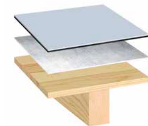
Hydroizolacja: BauderTHERMOFOL Warstwa rozdzielcza: Schutzvlies WB 300
